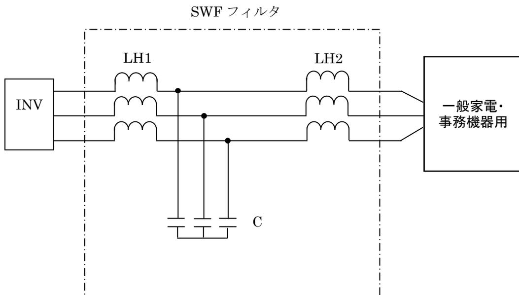
SWF 正弦波フィルタは、三相モータの「全負荷電流」、「kW 容量」およびインバータの「キャリア周波数」をもとに選定できます。モータ最大制御周波数が 60Hz 超過、異電圧や kW 容量、または、その他の PWM キャリア周波数での使用等についてはご相談ください。
