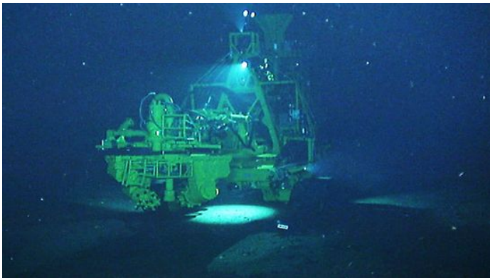
海底で作業を行う集鉱試験機
